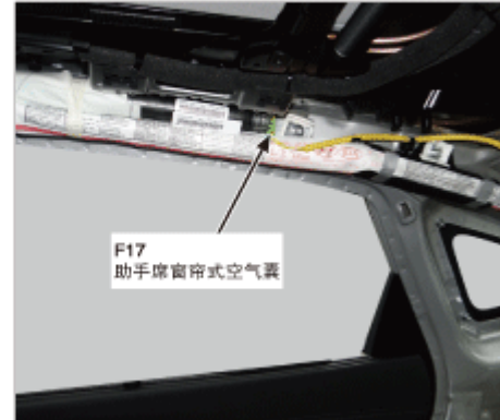
150.右侧C-立柱上部
